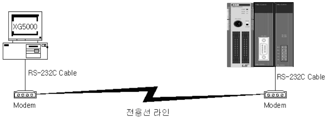
[그림 5.1.8] 전용모뎀을 통한 XG5000 리모트 접속 예
