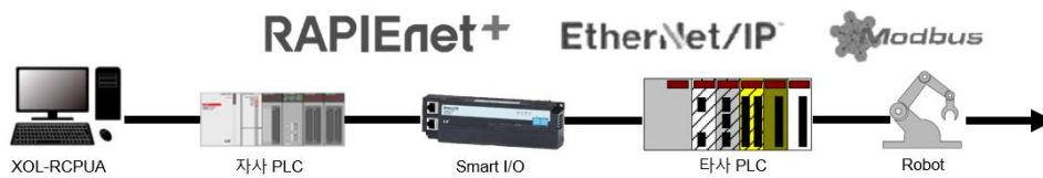
<RAPIenet+ 또는 Ethernet I/P, Modbus 를 이용한 Line 토폴로지 구성>
