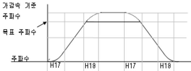
그림 7-17 가감속 기준 주파수 (H70)를 최대 주파수로 설정할 때
