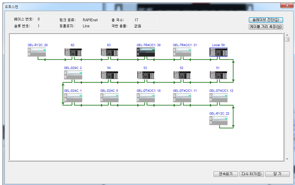
<제어그룹 정보 제공화면의 예: 50 번 마스터 모듈이 30 번 국번의 GEL-TR4C1 모듈을 제어함>
