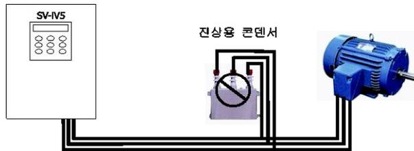
3. 인버터 출력과 전동기 사이의 배선길이는 300m 이내로 사용하십시오. 배선길이가 길 경우 배선정수에 따라 써지 전압이 모터 단자에 발생합니다. 더욱이 400V 급 모터에서는 써지 전압에 의해 절연이 악화되는 경우가 있습니다. 이러한 이유로 400V 급 모터를 인버터로 구동할 때는 절연이 강화된 모터 또는 써지 전압 저감 필터를 사용 하십시오.
